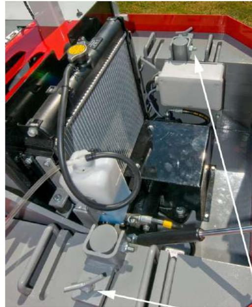
Abbildung 5.16 | Sicherung Ballastplatten – Prins Trike
