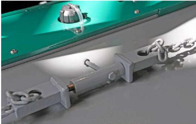
Abbildung 5.15 | Sicherung Ballastplatten – Prins Sprinter
