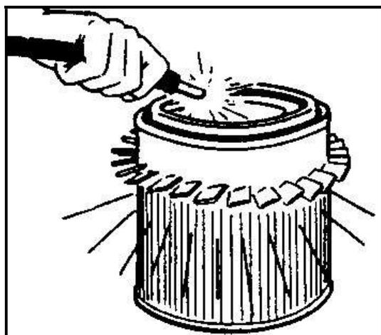
Abbildung 6.7 | Reinigung des Luftfilterelements
