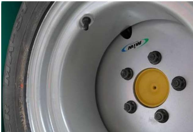
Abbildung 6.9 | Ventil Felgenaußenseite
