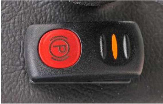
Abbildung 5.9 | Schalter Parkbremse
